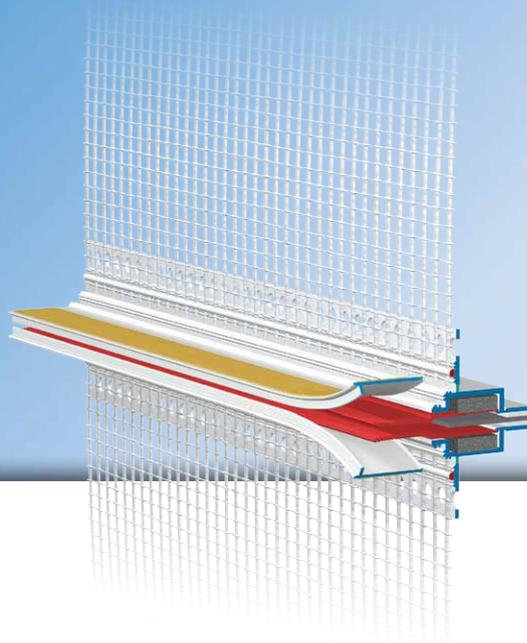
Das **APU-Dehnfugenprofil PUR-FIX** wird in Wärmedämm-Verbundsystemen bei vertikalen Gebäudefugen eingesetzt. Für die fluchtgerechte Ausbildung einer sauberen Putzkante kann das Profil in der Fläche sowie in der Innenecke eingesetzt werden.
