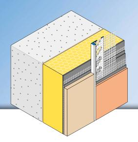
Das **APU-Abschlussprofil DECO-TEX** wird in Wärmedämm-Verbundsystemen als Putzabschluss oder Putztrennung von Oberputzen eingesetzt.
